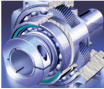
Patented planet carrier design 선기어 베어링을 플래닛 캐리어안에 위치시킴으로써 기어의 오배열을 줄여 높은 정밀도를 얻음.
