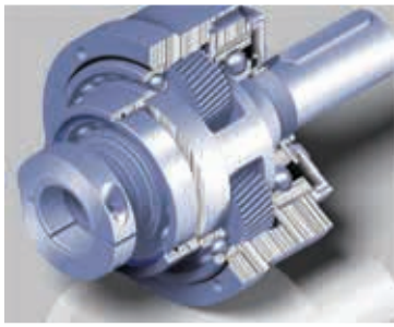
Patented planet carrier design 선기어 베어링을 플래닛 캐리어안에 위치시킴으로써 기어의 오배열을 줄여 높은 정밀도를 얻음.
