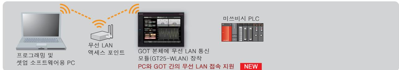
\* 무선 LAN을 사용한 데이터 전송에서는 주변 환경이나 설치 장소에 따라서 패킷의 손실이 일어나 유선에 비해 불안정할 수 있습니다. 반드시 동작을 확인 후에 사용하십시오.
